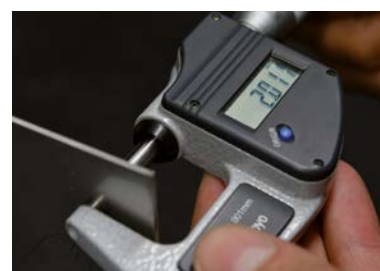
Raw material thickness test Verifica spessore
